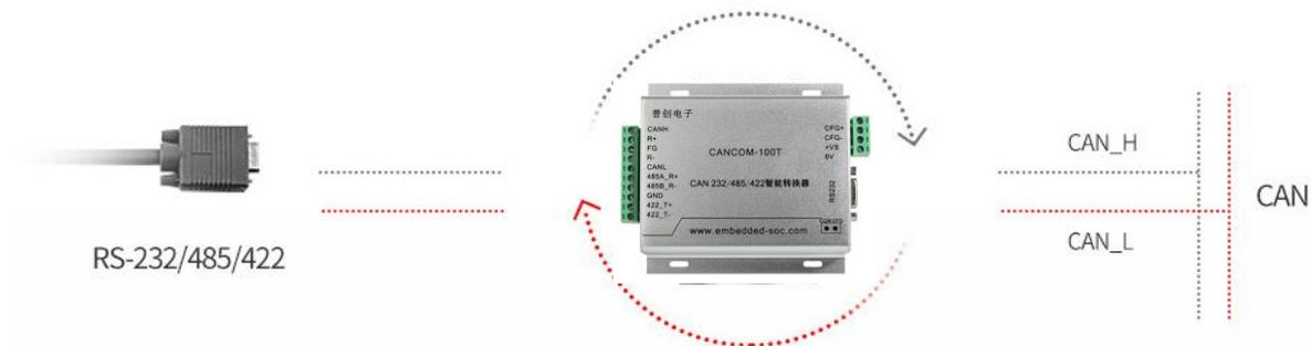
图1.2 CANCOM-100T 智能串口CAN转换器典型应用
